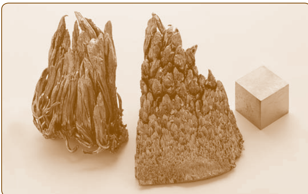
Yttrium, sublimiert-dendritisch, hochrein 99,99 % Y/TREM. Sowie für den Größenvergleich ein lichtbogengeschmolzener 1 cm 3 Yttriumwürfel aus 99,9 % Material.
